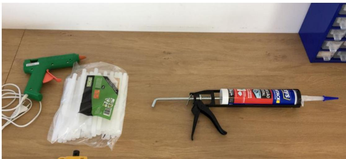
*Figura 28 - Substituição da cola quente por uma cola de maior resistência (Figura do autor).*
